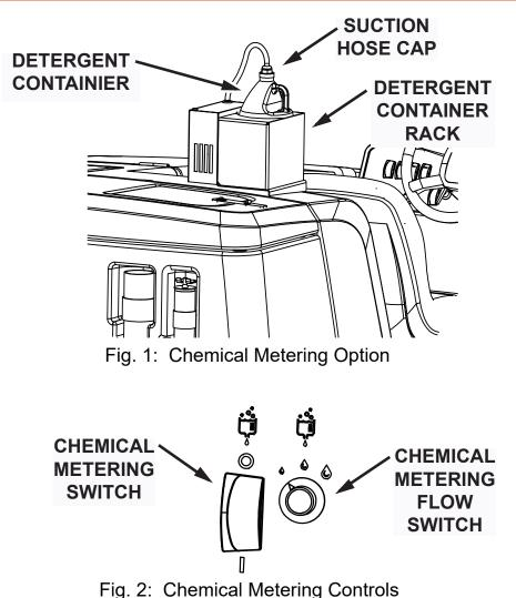
Fig. 2. Chemical Metering Controls
